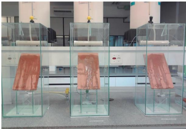
**Figura 12.** Teste de lixiviação por irrigação em execução.
