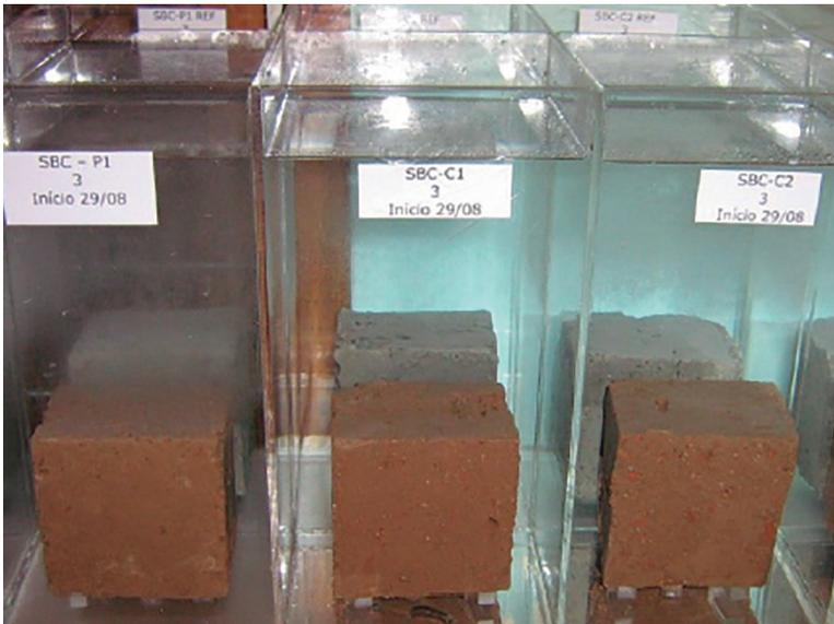
**Figura 7.** Ensaio de tanque. Fonte: Jacob (2012).
