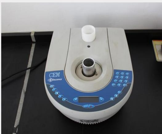
**Figura 11.** Sistema de irradiación por microondas (CEM) abierto, adaptado con un sistema de reflujo.
