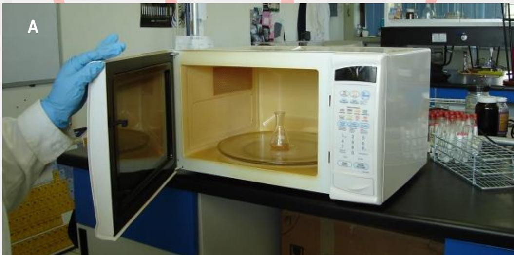
**Figura 3.** A) Sistema de calentamiento con microondas doméstico. B) Adaptación de un sistema de reflujo con hielo. En el matraz Erlenmeyer está la mezcla de la *o*-fenilendiamina sustituida, el aldehído líquido y el metabisulfito de sodio, en ausencia de disolvente. C) Sistema dentro del horno doméstico.
