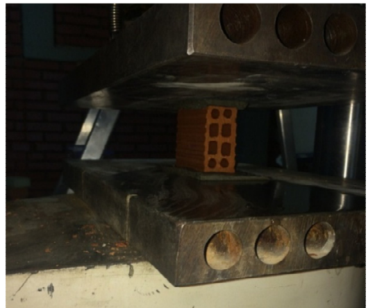
Figura 29. Prensa utilizada para romper corpos de prova Figura 30. Corpo de prova sendo comprimido
