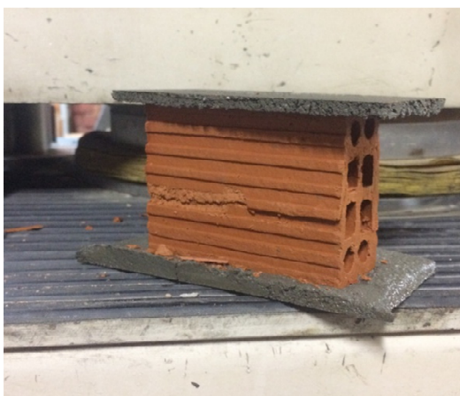
Figura 32. Corpo de prova rompido
