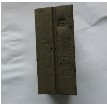
Figura 11. Corpo de prova timbrado- 10% de lodo
