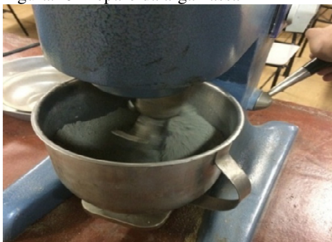
Figura 25. Preparo da argamassa
