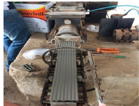
Figura 8. Modelagem mecanizada dos tijolos
