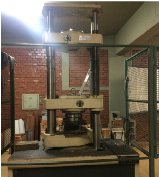
Figura 29. Prensa utilizada para romper corpos de prova Figura 30. Corpo de prova sendo comprimido
