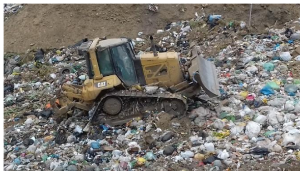
Figura 14 - Compactação de resíduos utilizando trator de esteira
