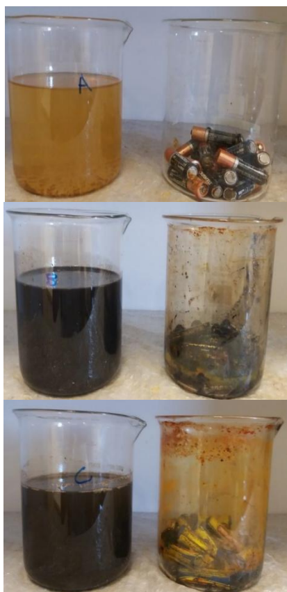
Figura 12. Retirada das pilhas do meio aquoso: (a) amostra A, (b) amostra B e (c) amostra C
