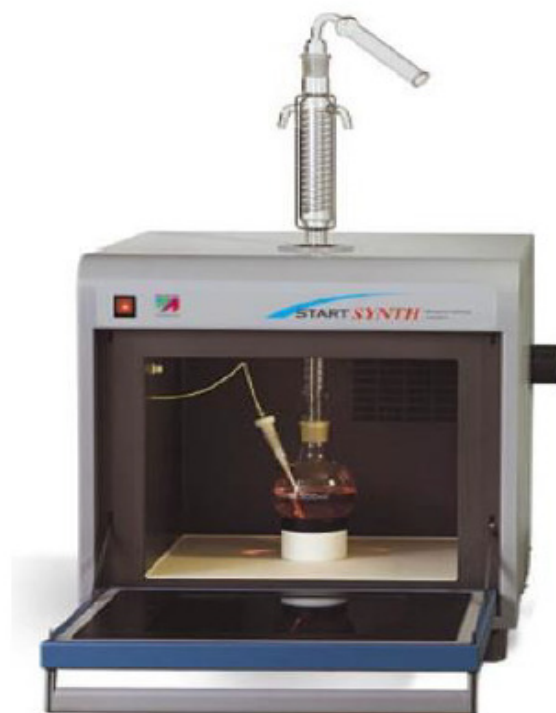
Figura 2 - Fotografia do esquema montado usando o aparelho de micro-ondas do tipo START SYNTH na síntese do biodiesel. As condições de síntese (potência, tempo e agitação (%)) são selecionadas no programa do aparelho.
