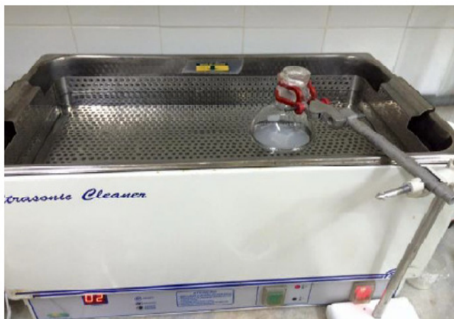
Figura 3 - Fotografia da montagem do sistema usando o aparelho de ultrassom ULTRASONIC CLEANER utilizado para a síntese do biodiesel. Sobre o balão foi montado um sistema de refluxo.
