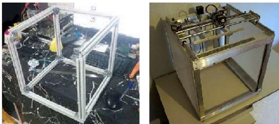
**Figura 2.** Construção de impressora 3D artesanal de baixo custo – FCA / UFGD
