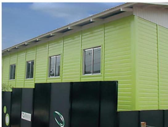
Figura 4 - Instalação provisória pré-fabricada em painéis estruturais em madeira tipo pinus.
