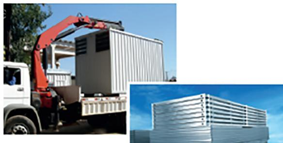
Figura 10 - Transporte dos contêineres montados ou desmontados. Fonte: <http://www.eurobras.com.br/>
